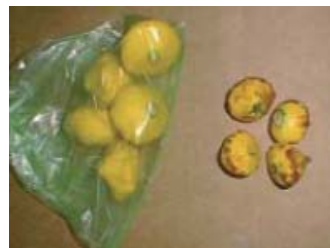
Ejemplos de sistemas activos. Izda: Absorbedor de etileno en sobres. Dcha: Absorbedor de etileno incorporado en el material plástico.
